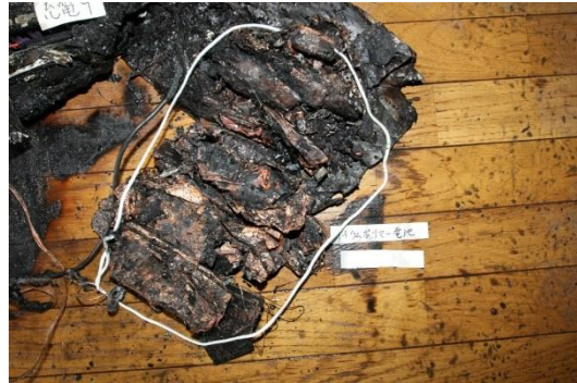
写真 1-2 焼損した電池
