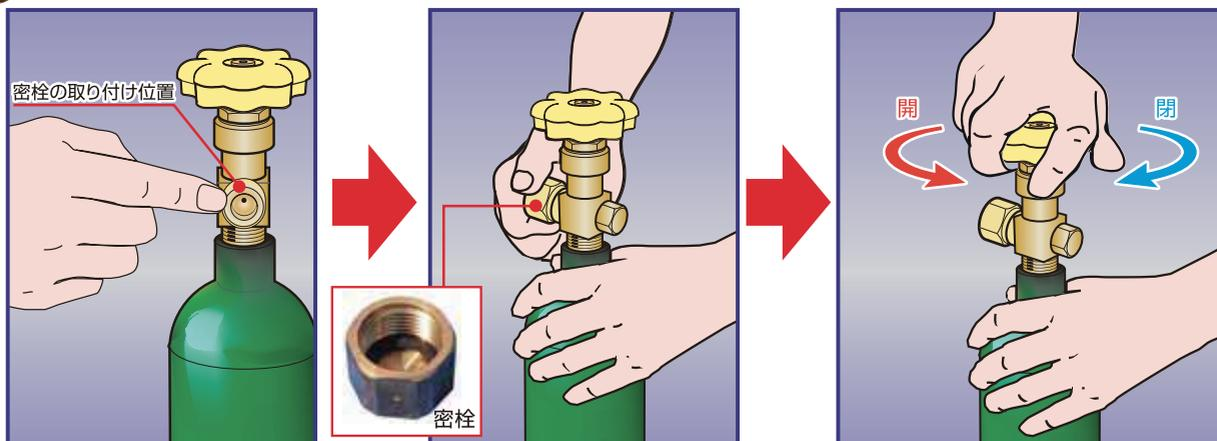
薬剤貯蔵タンクから加圧用ガス容器を取り外した後、密栓※1を容器弁に取り付けるなど、容器からガスが漏れないように措置します。
