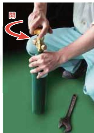
6ヶ月毎の機器点検について、移動式粉末消火設備等の加圧用ガス容器のバルブ類の開放点検を追加し、容器弁の開放ができることを確認します。点検実施後、加圧用ガス容器に容器弁バルブ類点検済証(裏面2参照)を貼付します。
